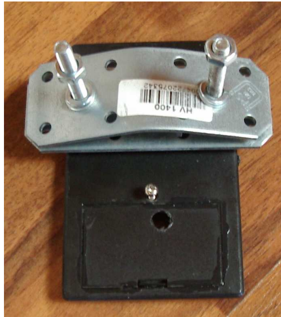
Particolare delle piastre di fissaggio fissate nel coperchio in ABS
